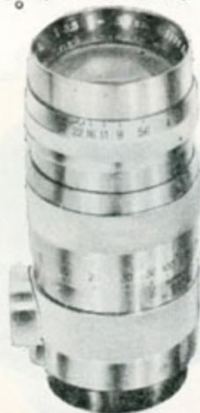
高速長焦点レンズです。大口径レンズにもかかわらず画像は極めて平坦で周辺部まで最高解像力を示しています。特にレンズを開放した時に最高の性能が發揮されます。両角28度30分。最少絞F32。最短撮影距離三・五フィート。黒色耐腐性軽合金鏡胴を採用し重量は五〇〇瓦。三脚ネジ穴付。レンズ構成は三群七枚。レンズフード、皮ケース付。
