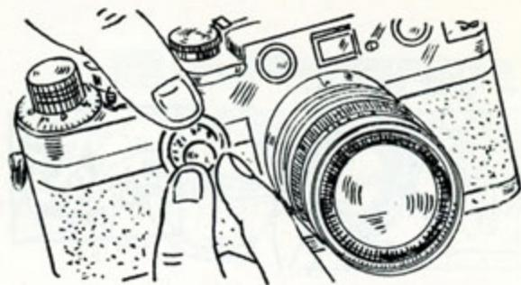
(7) 低速シャッターを使用する時には、このシャッターダイヤルを使用します。
