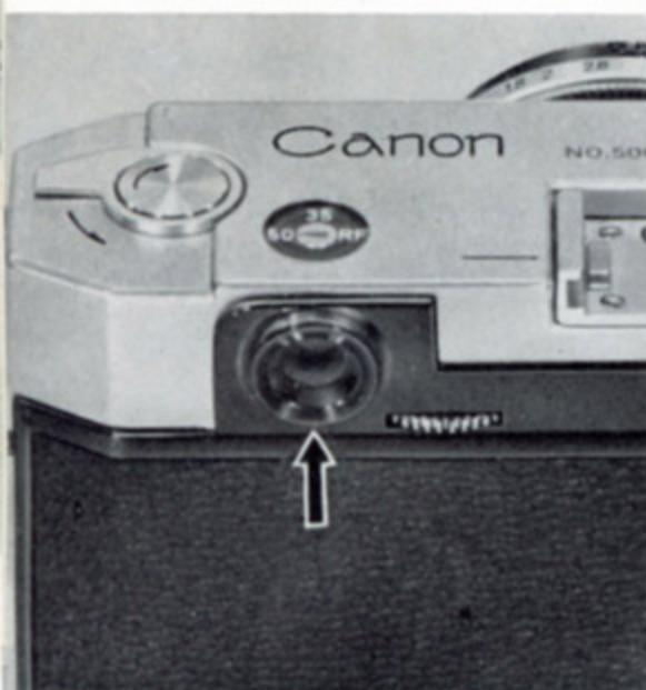
二重像を合わせるには主被写体の像が、中央の円形輪廓の中心に見えるようにします。特に近距離被写体に対しては大切です。
