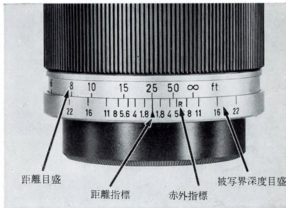
赤外指標は  $8000\text{\AA}$  程度の波長に最大感度を持つフィルムと赤外フィルター（たとえばコダック IR 185 フィルムとラッテン 87 フィルター）とを用いる場合を標準にして目盛ってあります。赤末部を使用する場合、たとえばプラス X、あるいは一般のパンクロフィルムにラッテン 25 程度の赤色フィルターを添用する際などには、修正移動を  $1/3$  位とするのが適当です。
